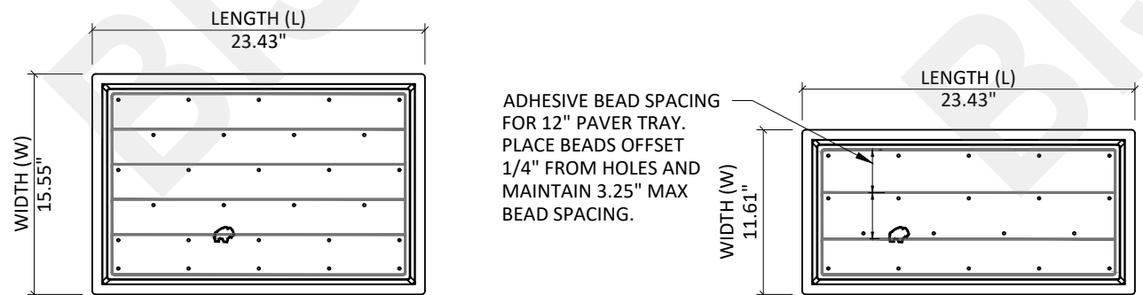
T3 BISON 16 x 24 PAVER TRAY - TOP VIEW SCALE: 1" = 1'-0"
